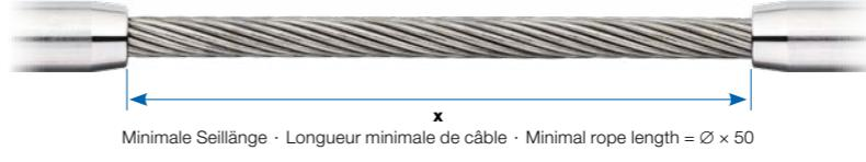
Minimale Seillänge · Longueur minimale de câble · Minimal rope length = Ø × 50
