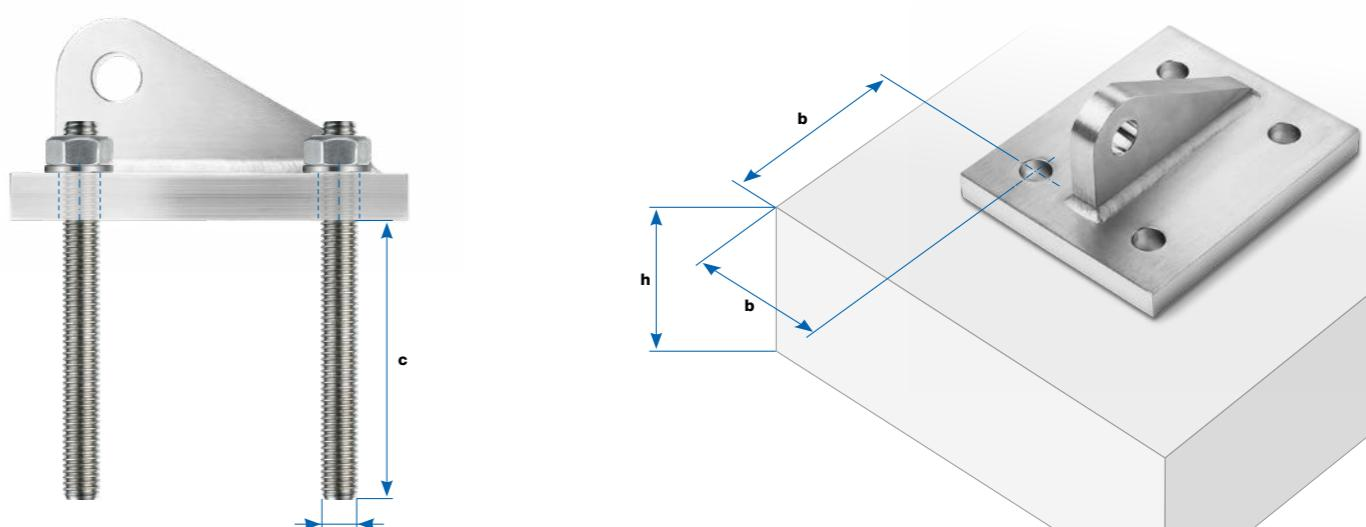
■ Die Verankerung muss mindestens den Bauteilwiderstand gemäss Tabelle übertragen können. Dies ist mit Verbundankern von gängigen Herstellern unter folgenden Bedingungen möglich:
