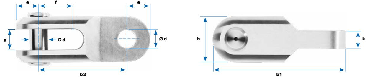
■ Bei abweichender Seilausrichtung durch veränderliche Belastungen kann der Toggle Forte eingesetzt werden, um Biegungen auf den Seilbeschlag und auf die Lasche zu minimieren.
